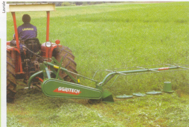
Segadoras rotativas a disco permitem o corte a uma velocidade de 20 Km/h
