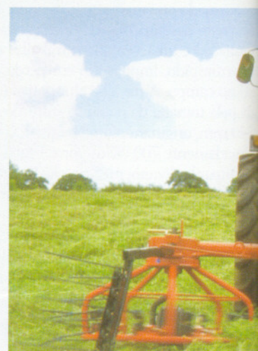
Os ancinhos de barras transversais varrem a forragem para o centro formando a leira
