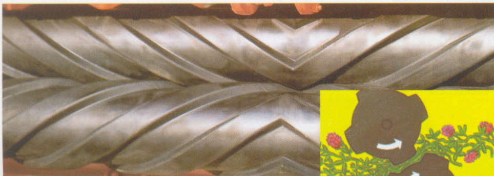
Rolos com pressão ajustável por molas amassam a forragem
