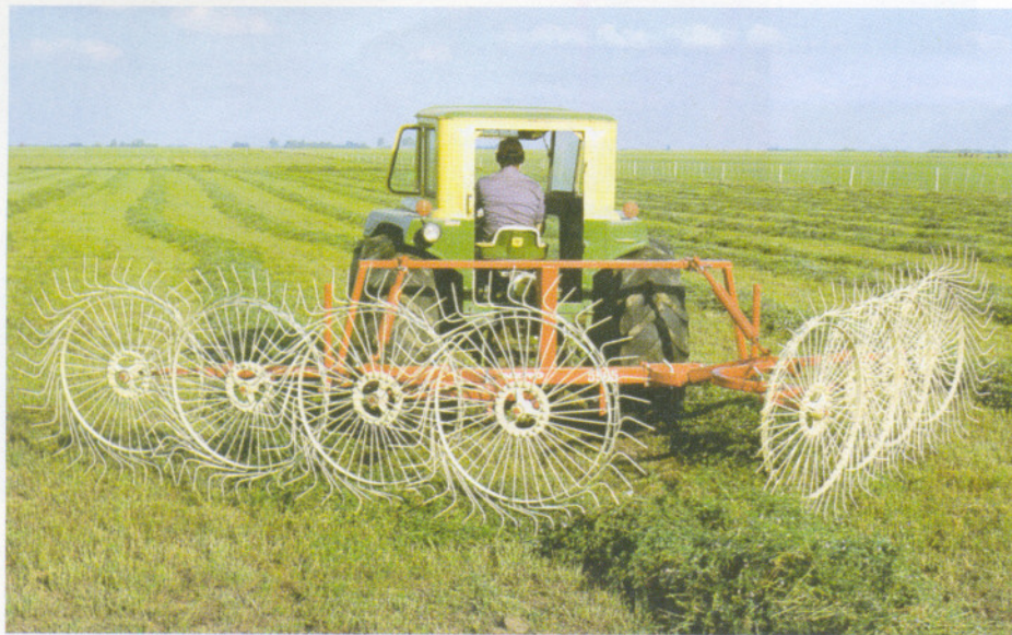
Ancinho de rodas dentadas verticais pode ser usado para enleirar ou revolver leiras
