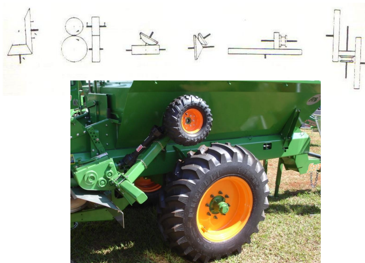
Figura 7. Diferentes tipos de arranjos de transmissões com rodas de atrito e exemplo de roda de atrito em uma adubadora, que em contato com o pneu, e com a máquina em movimento, passa a acionar o mecanismo que dosa a quantidade de adubo que será aplicada
