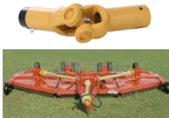
Figura 12. Junta universal e seus componentes e roçadora com sistema de transmissão de juntas universais e cardans
