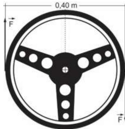
Figura 1.26 Volante de direção de um automóvel sob a ação de duas forças de mesma intensidade, coplanares paralelas e opostas.
