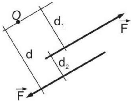
Figura 1.25 Esquema representando duas forças de intensidade  $F$  causando um binário em torno do ponto  $O$ .
