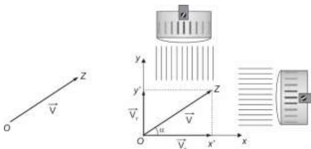
Figura 1.16 Projeção ortogonal do vetor  $V$ .
