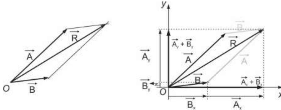
Figura 1.19 Soma dos vetores A e B pelo método do paralelogramo e das projeções ortogonais.
