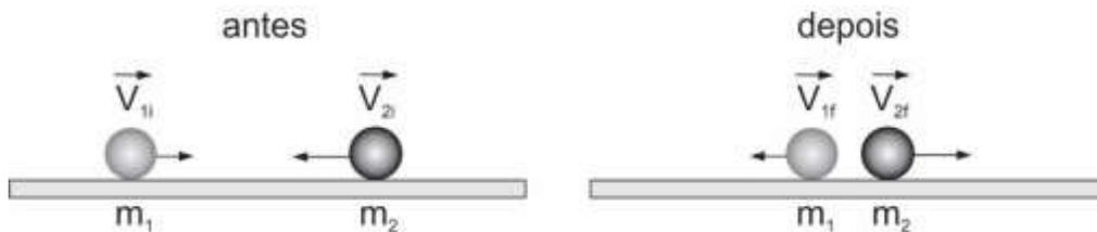
Figura 1.21 Choque perfeitamente elástico entre duas esferas.
