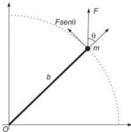
Figura 1.23 Esquema de forças que atuam sobre uma partícula de massa  $m$  forçada a girar em torno do ponto  $O$ , fixo.
