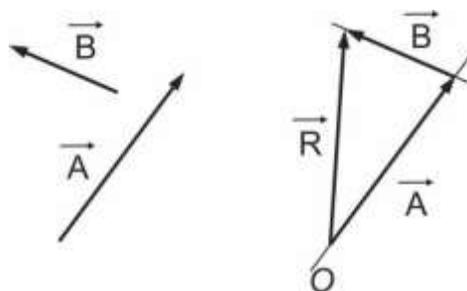
Figura 1.9 Determinação do vetor resultante das ações dos vetores A e B.
