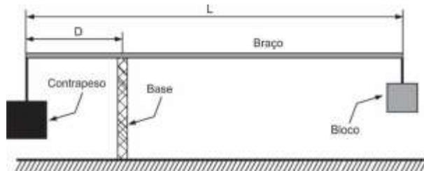
O braço do guindaste é homogêneo, tem uma massa  $M_{br} = 400$  kg e o comprimento  $L = 15,0$  m. O contrapeso tem massa de  $M_{cp} = 2,0 \times 10^3$  kg e está pendurado a uma distância  $D = 5,0$  m da base. Nessas condições o sistema se encontra em equilíbrio. Considere  $g = 10$  m/s<sup>2</sup>.
