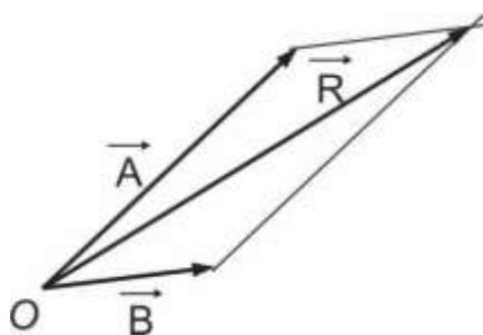
paralela ao vetor B e pela ponta do vetor B uma reta paralela ao vetor A, de modo a completar o paralelogramo. O vetor resultante R, será representado graficamente com o segmento de reta situado na correspondente diagonal do paralelogramo.
