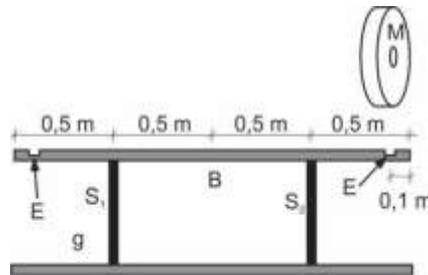
24 Um guindaste é composto de um braço, apoiado em uma base vertical, e um contrapeso pendurado em uma de suas extremidades. A figura mostra esse guindaste ao sustentar um bloco na extremidade oposta.
