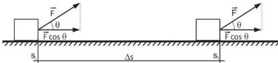
Figura 1.22 Deslocamento, por ação de uma força constante  $F$ , de um bloco de massa  $m$ , num percurso entre as posições  $s_i$  e  $s_f$ .
