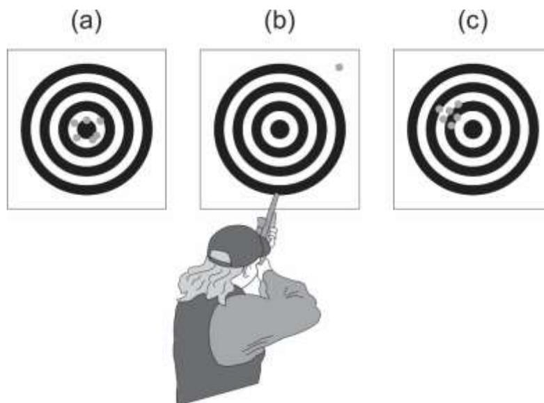
Figura 1.3 Erros no tiro ao alvo e sua analogia com os erros de medição: (a) aleatórios; (b) grosseiros; (c) sistemáticos.
