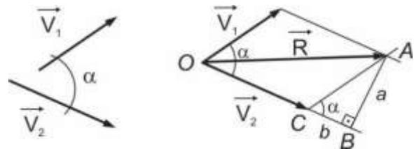
Figura 1.13 Representação das relações geométricas na ação de duas grandezas vetoriais coplanares.
