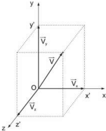
Figura 1.20 Projeção do vetor  $V$  nos eixos  $x$ ,  $y$  e  $z$ , num referencial newtoniano.
