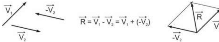
Figura 1.12 Subtração de vetores pelo método do paralelogramo.
