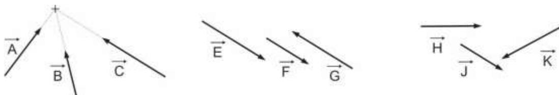
Figura 1.8 Vetores coplanares concorrentes: (A, B e C); vetores coplanares paralelos (E, F e G); vetores coplanares não concorrentes não paralelos: (H, J e K).
