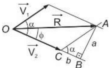
Figura 1.14 Determinação da direção  $\phi$  entre a resultante  $R$  e  $V_2$ .
