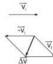
Figura 1.27 Partícula descreve movimento circular uniforme (MCU) com velocidade  $v$ .
