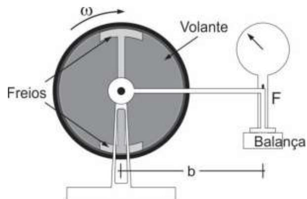
Figura 1.29 Freio dinamométrico.
