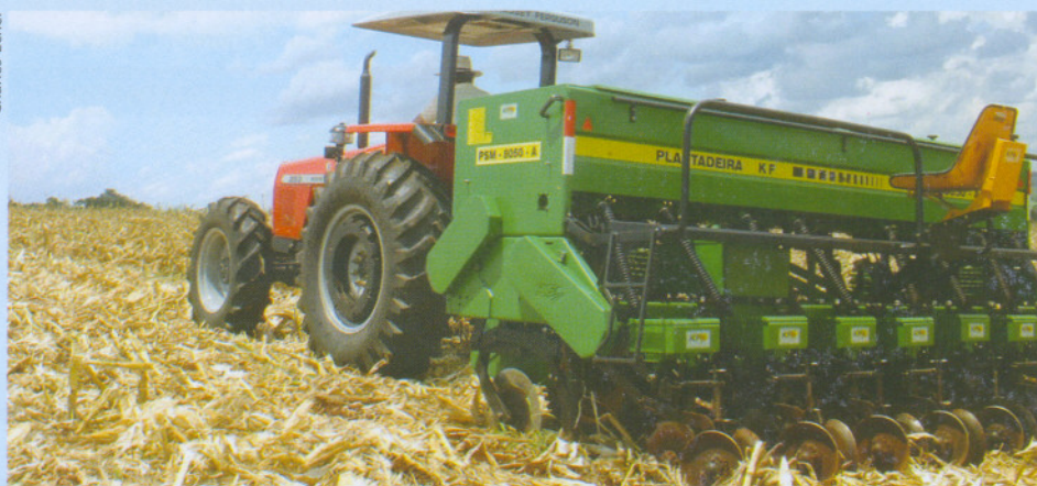
Após o uso do equipamento de distribuição do fertilizante é necessário deixá-lo limpo e protegido por uma camada de óleo para evitar a sua oxidação
