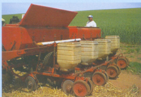
Esvaziar os reservatórios de adubo é um dos cuidados que deve ser tomado com a máquina
