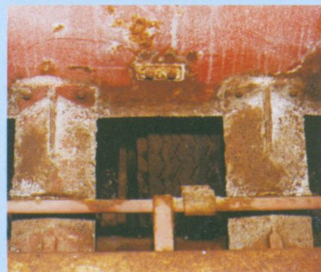
Oxidação de componentes da semeadora por problemas com limpeza e lubrificação
