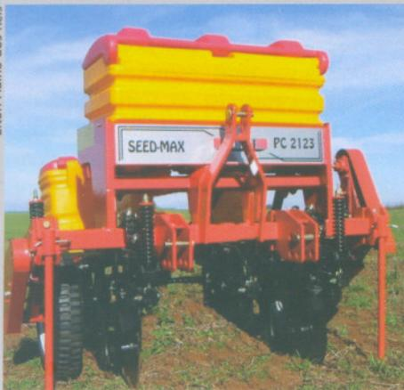
Máquina utilizada no ensaio, com um conjunto formado por disco de corte mais facção e outro por disco de corte mais disco duplo defasado
