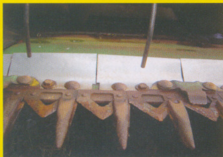
Desgaste das navalhas e dos dedos das navalhas de corte
