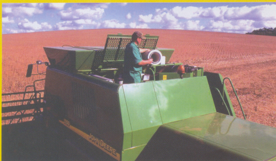
Limpeza e troca periódica do filtro de ar garantem maior vida útil à máquina
