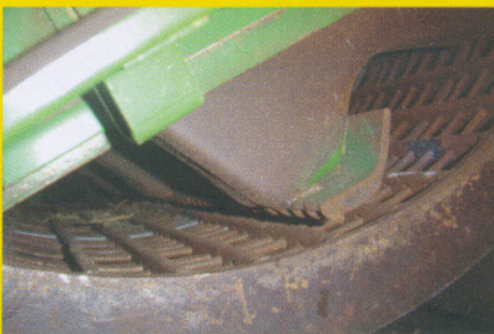
Defeitos na unidade de trilha causam danos aos grãos na colheita
