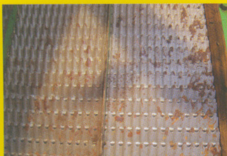
A folga nas peneiras e o alinhamento das telas devem ser verificados
