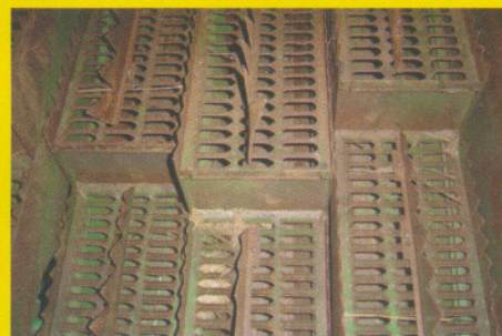
Saca-palhas sem obstrução nas telas
