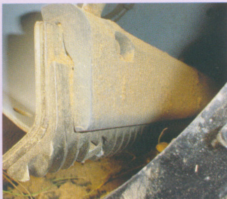
Barra emborrachada do cilindro de trilha da colhedora MF 34
