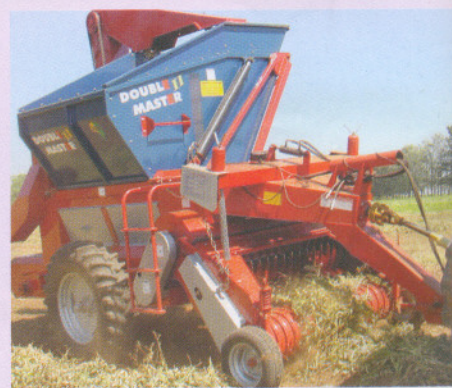
Na extremidade do cilindro trilhador há um rotor de aletas que lança a palha para fora da máquina
