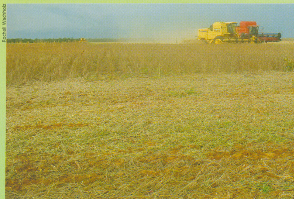
Em anos com deficiência hídrica as plantas apresentam uma inserção de vagens baixa propiciando um aumento no não recolhimento, exigindo regulagens especiais da máquina
