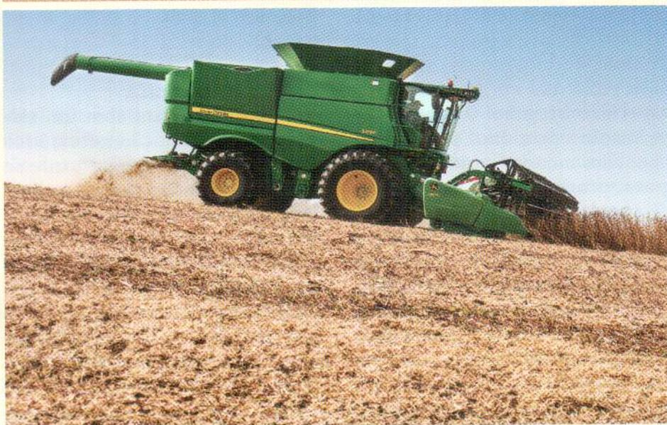
A S690 possui sistema *HarvestSmart* que permite controlar a velocidade de colheita em função das perdas, cargas do motor e pressão de material no rotor
