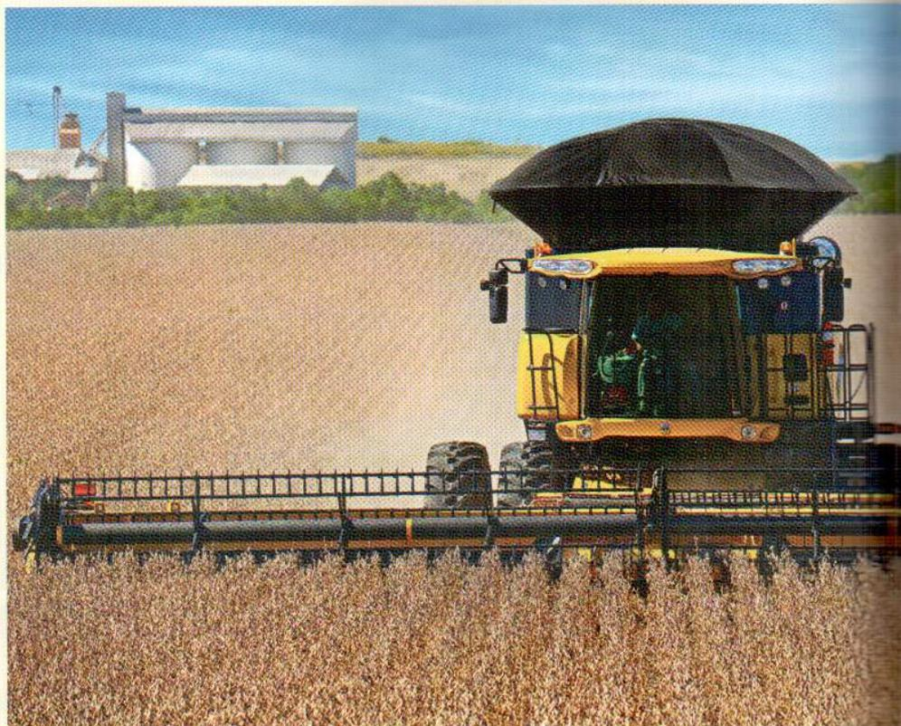
modo um pode ser definido para velocidades normais, já o segundo quando velocidades mais elevadas são necessárias durante a colheita ou deslocamento da máquina. Para ambos os modos, a velocidade pode ser infinitamente variada, por
