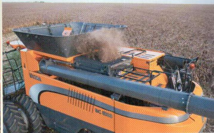
As colhedoras MF 9895 e BC 8800 possuem sistema automático de autolimpeza dos radiadores de arrefecimento do motor
