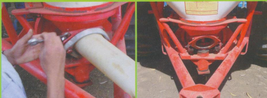
Exemplo de retirada do pêndulo de um distribuidor inercial
