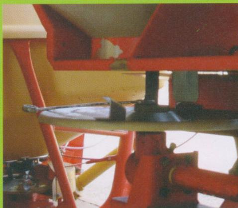
Detalhe do disco distribuidor e coleta do material para distribuidores centrífugos
