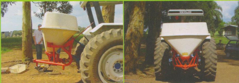
O equipamento deve ser nivelado longitudinal e verticalmente
