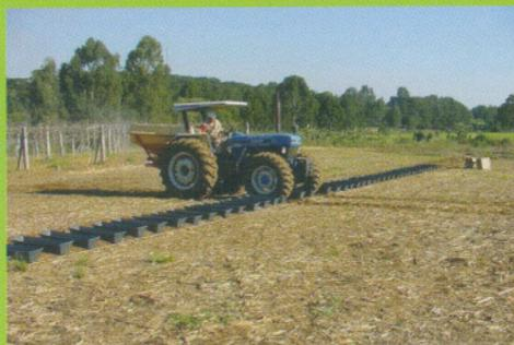
Passagem do conjunto trator/distribuidor sobre os coletores e coleta de material em sacos plásticos
