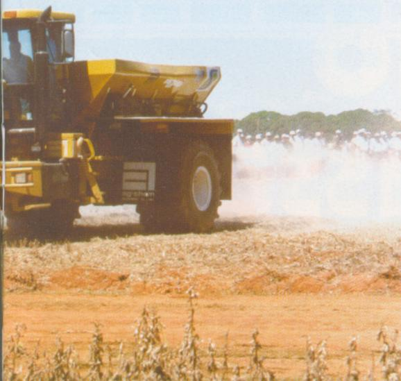
servatório abastecido com 50% de sua carga máxima, aciona-se o mecanismo, coletando o material em períodos de 30 segundos para posterior pesagem. A partir dos dados obtidos na coleta e pesagem dos produtos, determina-se a curva de calibração da máquina.
