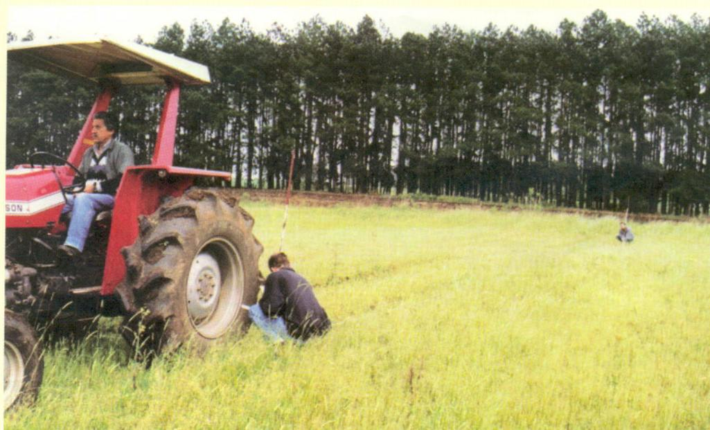
Fig. 14 - O método de determinação do patinamento de um trator é extremamente fácil de ser aplicado e muito útil para a adaptação do trator às condições de trabalho
