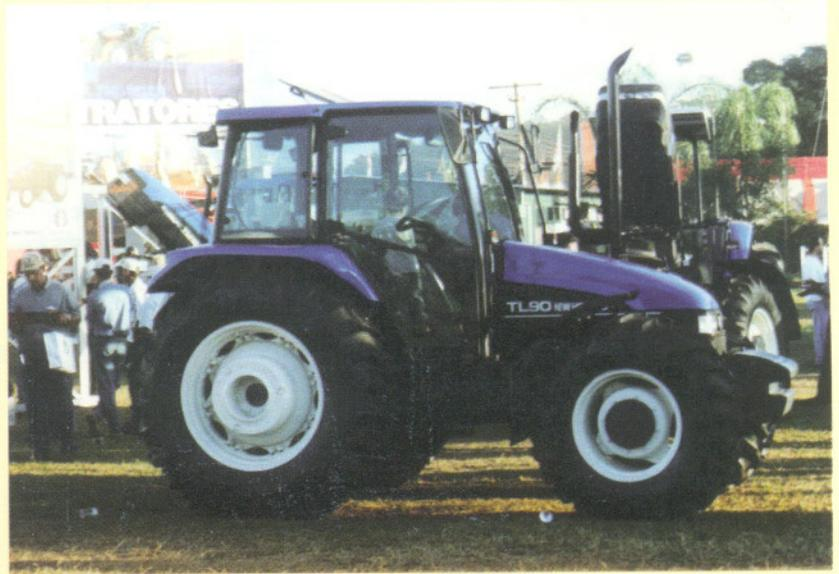
Não existe uma quantificação de uma relação peso/potência correta, mas seguramente para velocidades de operação entre 6 e 8 km/h um trator TDA deve ter relação peso potência entre 60 e 80 kg/kW, como mínimo. Relações menores indicam que o trator deve ser lastrado, ou operado a maior velocidade, o que nem sempre é possível pelas características do implemento que está sendo utilizado.
