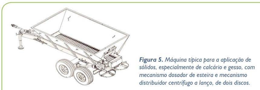
**Figura 5.** Máquina típica para a aplicação de sólidos, especialmente de calcário e gesso, com mecanismo dosador de esteira e mecanismo distribuidor centrífugo a lanço, de dois discos.
