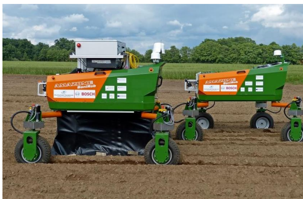
Figura 7 – Veículos autônomos utilizados no controle de plantas daninhas, mensuração da resistência mecânica do solo e fenotipagem automatizada. Estes equipamentos dispensam os operadores
