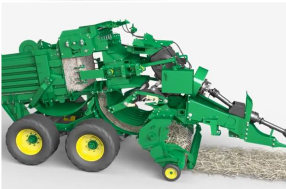
Figura 12 – Enfardadora e a operação de recolhimento e enfardamento de feno, parte dos processos ocorrem fora da máquina e parte em seu interior.
