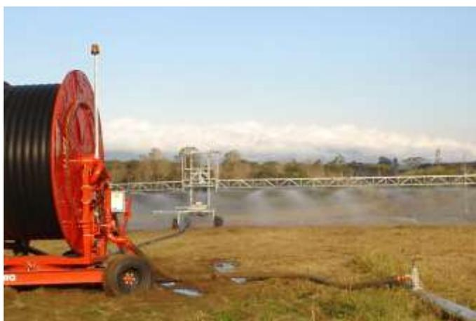
Figura 10 – Barra irrigadora tracionada por carretel enrolador
