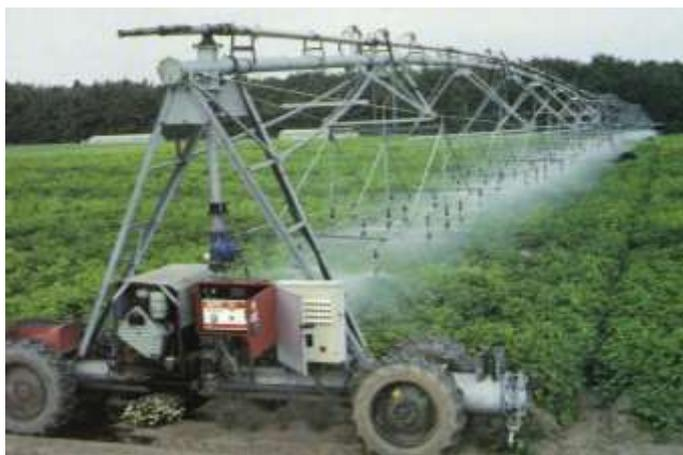
Figura 5 – Sistema mecanizado de aspersão com deslocamento linear contínuo
