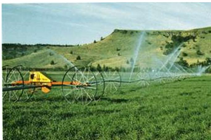
Figura 6 – Sistema mecanizado de aspersão com deslocamento linear intermitente
