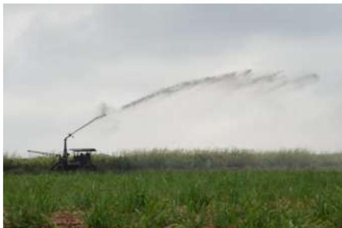
Figura 11 – Aspersor canhão montado sobre uma unidade móvel de bombeamento
