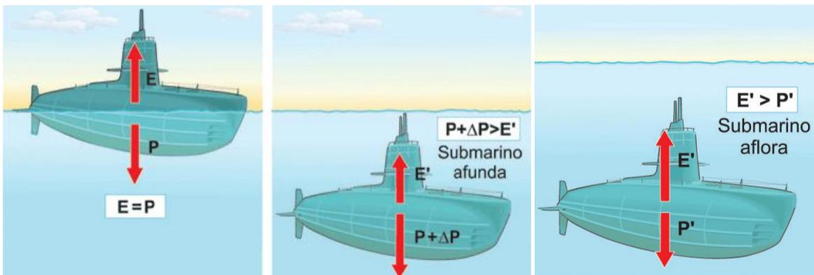
Empuxo agindo sobre o corpo:  $E = \gamma_{\text{liq}} \cdot \text{Vol}_{\text{corpo}}$
