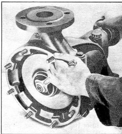
fig. 12 Retirada da porca do rotor
